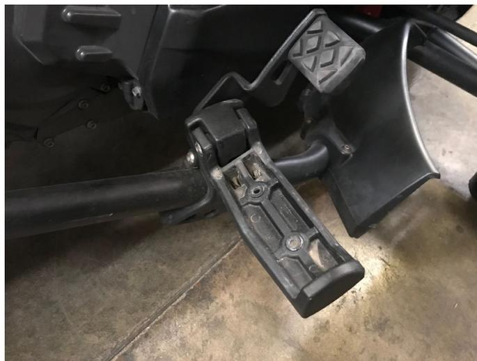
**2.- Remove the frame support arm bolt.**
